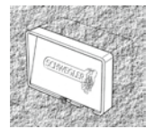
▲ Bild 4: Unter Putz.
